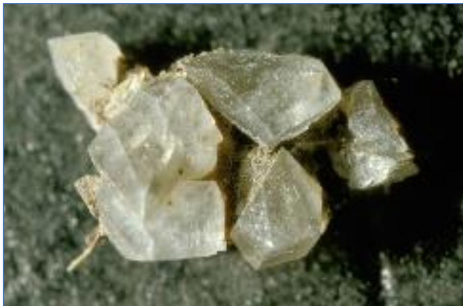
Figura 11. Cristales de estruvita obtenidos en una planta de procesamiento de estiércol líquido de Hannover (Alemania). Ancho de la imagen: 7,5 mm (Wikipedia, agosto de 2020).
